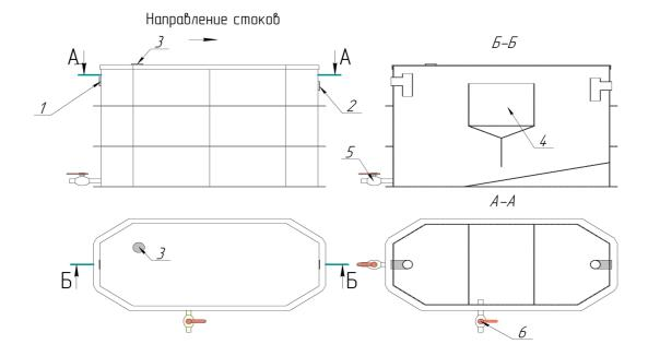
рис 1. Схематичный чертеж жироуловителя «Салма».
